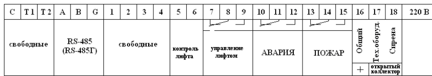
Рис. 5. Схема подключения ПДУ. Выход СИРЕНА дублирует внутреннюю звуковую сигнализацию
